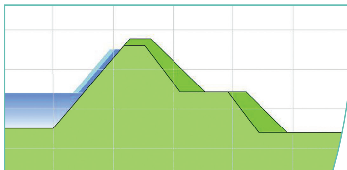
Figuur 2 – Schematische weergave van een maatregel in grond in KosWat. De te nemen maatregel als gevolg van de toegenomen hydraulische belasting is donkergroen gekleurd (in dit geval verhogen kruin en verflauwen binnentalud).
